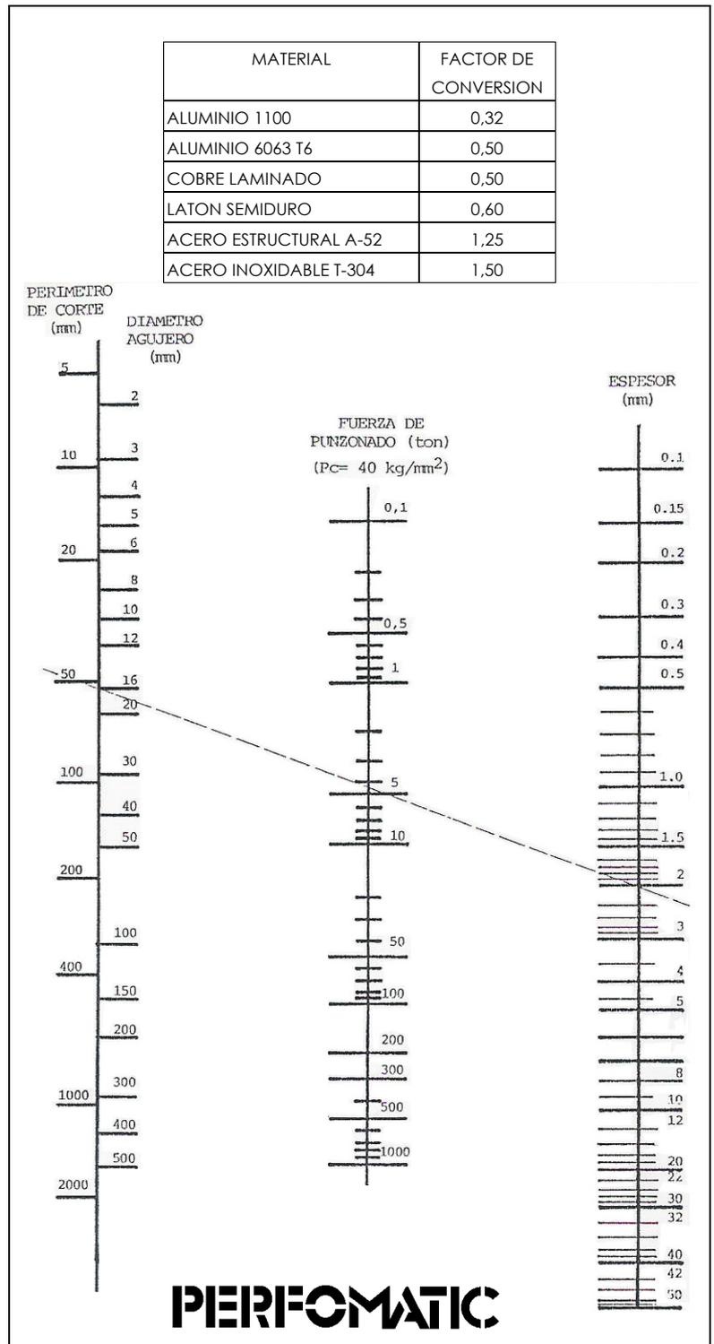
El **NOMOGRAMA** está preparado para materiales de Rc = 40kg/mm<sup>2</sup>, por lo que puede usarse con suficiente margen de seguridad para la determinación rápida de la fuerza necesaria para el punzonado de la mayoría de las chapas y perfiles de acero de calidad comercial, de uso común en la industria, empleando punzones y matrices de calidad rec nocida con la luz correcta de acuerdo al material y espesor a punzonar.
